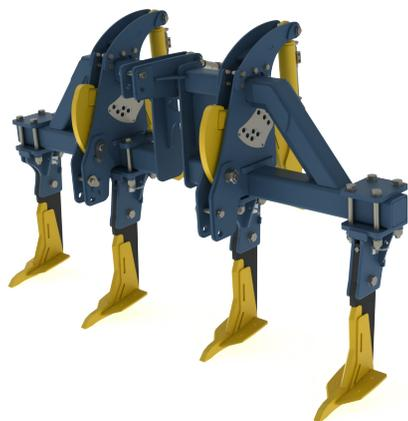
**Il decompressore serie BLADE, è un attrezzo che permette una lavorazione di arieggiatura del terreno, creando una fessura nel suolo che non causa nessun rivoltamento superficiale, mantenendo il terreno umido, preservando la biodiversità e garantendo una migliore resistenza alla siccità.**
