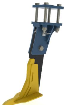
Il vomere è in acciaio al boro temprato ( 30MnB5 ) con punta riportata per una migliore resistenza all'usura. I coltri laterali possono essere allungati tramite alette avvitate sopra di essi.
