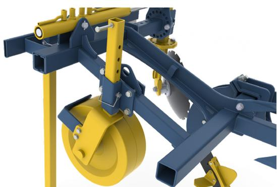
La macchina viene equipaggiata, di serie, con una ruota di profondità in ferro di  $\varnothing 400 \times 150$ . Quest'ultima, regola la profondità di lavoro della macchina e ne permette una prestazione costante con una resa ottimale.
