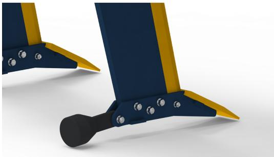
Nel retro dello scarpone è possibile avvitare una talpa di vari diametri che ha la funzione di creare un tunnel drenate nel sottosuolo.
