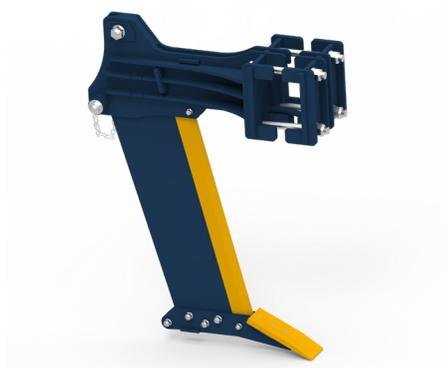
Il gruppo ancora può essere anche avvitato, composta da una lamiera spessore 30mm in Hardox con un coltello e scalpello in acciaio al boro temprato.
