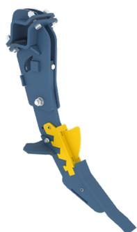
Questo particolare tipo di ancora è stato pensato per un rimescolamento ottimale della terra. La forma delle ancore, pensata con un'angolazione aggressiva, favorisce il sollevamento del terreno e ne consente, inoltre, una minore richiesta di potenza.
